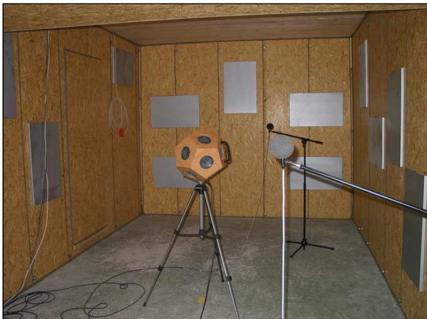
**Abbildung 88 Reflektoren an den ER-Wänden**
