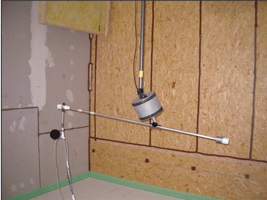
**Abbildung 82 abgehängtes Mikro im SR mit Schwenkmotor**
